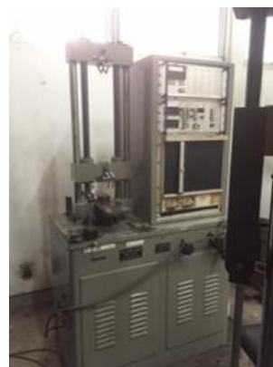
Gambar 4. Foto Alat UTM (Mettler Toledo AL 204) untuk mengukur kekuatan tekan sampel uji.
