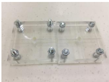
Gambar 1. Cetakan dengan diameter 3mm dan tinggi 6mm untuk membuat sampel penelitian
